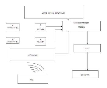
Fig. 2. RFID Block Diagram
